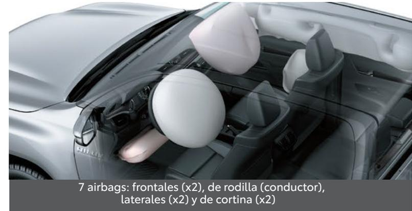
7 airbags: frontales (x2), de rodilla (conductor), laterales (x2) y de cortina (x2)
